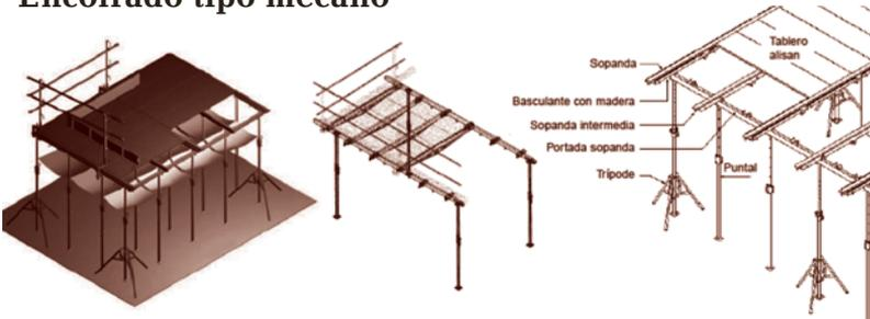
El encofrado tipo mecánico es un encofrado consistente en un mecanismo de acero, madera o aluminio de fácil montaje y adaptable a cualquier superficie, formando una base plana y resistente que permite la construcción de forjados planos de hormigón armado, macizados y aligerados.
