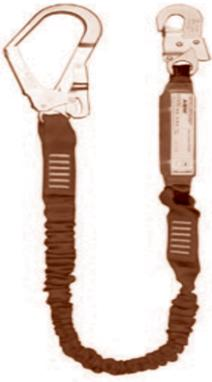
Es un equipo constituido por una бага de amarre, que lleva incorporado un elemento de absorción de energía. Generalmente se trata de dos cintas textiles imbricadas o cosidas, constituyendo una única pieza que se presenta plegada sobre sí misma y enfundada en un material plástico.
