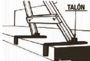
Los **pescantes** están diseñados para ser instalados a caballo sobre las azoteas y asegurados mediante contrapesos. Pueden ser metálicos siempre que las azoteas sean de hormigón armado. También pueden estar fijados en puntos de anclaje situados sobre la parte superior del edificio. Se componen de pluma, cola y caballete.
